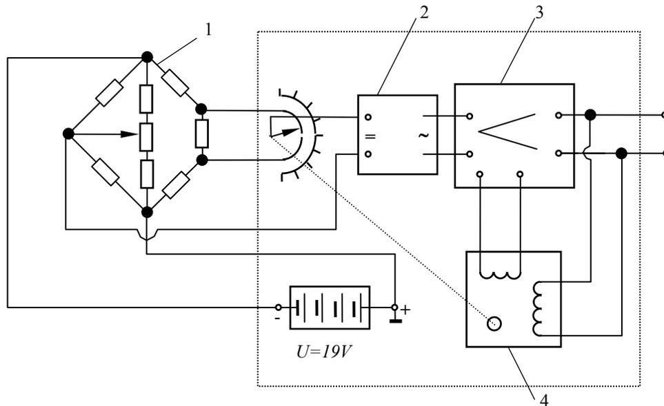
**Fig. 3 Deformation meter Diagram**
